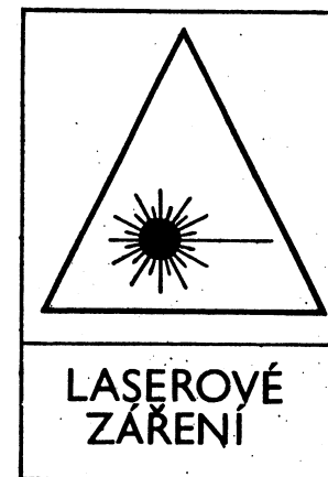
Obr. 15.3: Výstražná tabulka pro označení prostorů, ve kterých se používají lasery II. a III.a třídy
